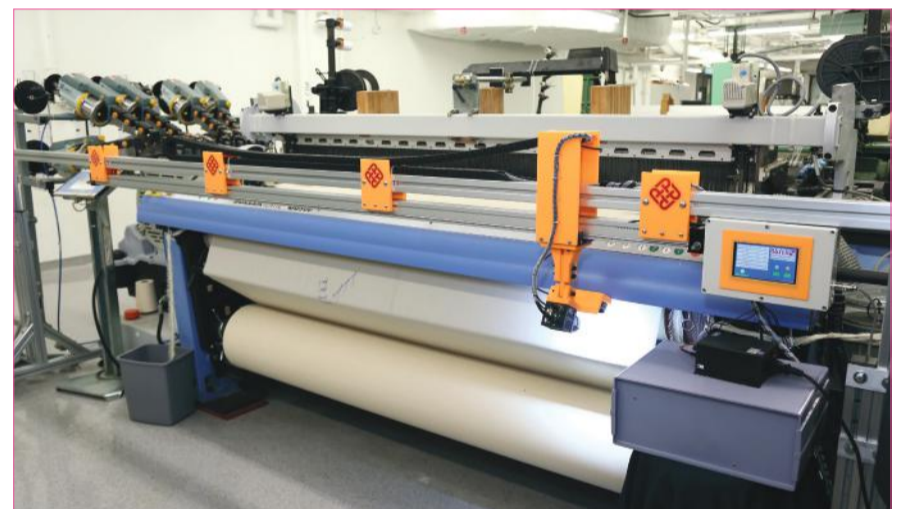
"WiseEye" integrated on a weaving machine "WiseEye" intégré à une machine à tisser
