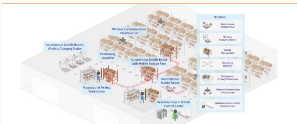
Conceptual diagram of the IIoT based Smart Robotic Logistics Management System Diagramme conceptuel du Système Intelligent de Gestion Robotisée pour Logistique basé sur l'IIoT
